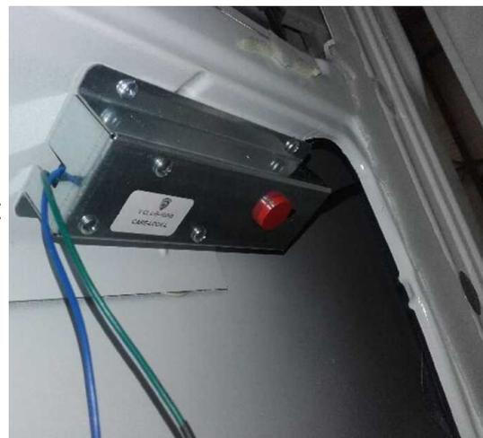
Pour monter le puits de gâche à ailette fourni sur le montant arrière fixe de la porte, il suffit de badigeonner le pêne de peinture et le faire sortir une fois la porte fermée, grâce au bouton rouge de manière à marquer le montant de l'encadrement : vous avez l'emplacement du trou du puits de gâche.
