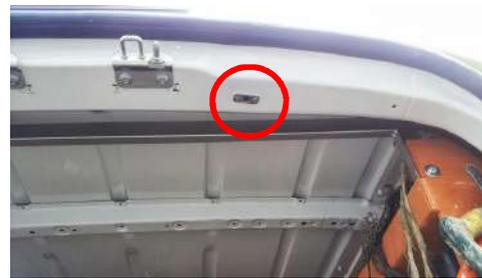
Stützwinkel und Riegel ausgefahren
