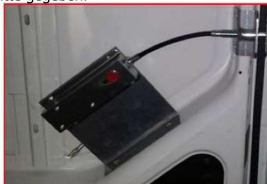
4 - Befestigen Sie die Lasche mit dem Riegel und schieben Sie den Riegel heraus --> das gibt Ihnen die Höhe, auf der Sie Teil C des Verschlusses befestigen müssen.
